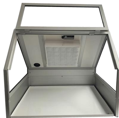
Cabine d'aspiration pour filtration HEPA Filtre HEPA H14 laissant passer au maximum 0.005% des particules de 0.1 micron Débit nominal : 150 m 3 /h Dimensions : 420 x 341 x 146 mm
