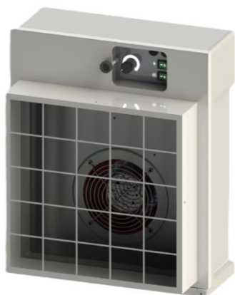
Cabine d'aspiration pour filtration HEPA Filtre HEPA H14 laissant passer au maximum 0.005% des particules de 0.1 micron Débit nominal : 150 m 3 /h Dimensions : 420 x 341 x 146 mm
