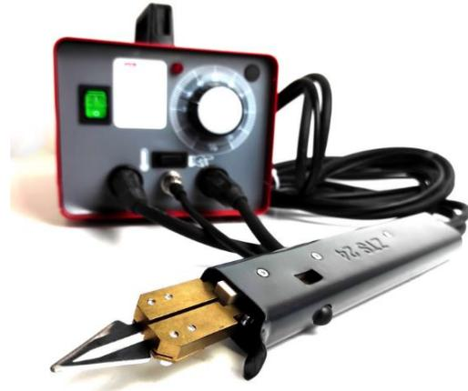
L'utilisation d'un couteau thermique permet le dégainage de câbles de gros diamètre, là où une simple dénudeuse thermique à électrodes chauffantes est inopérante.
