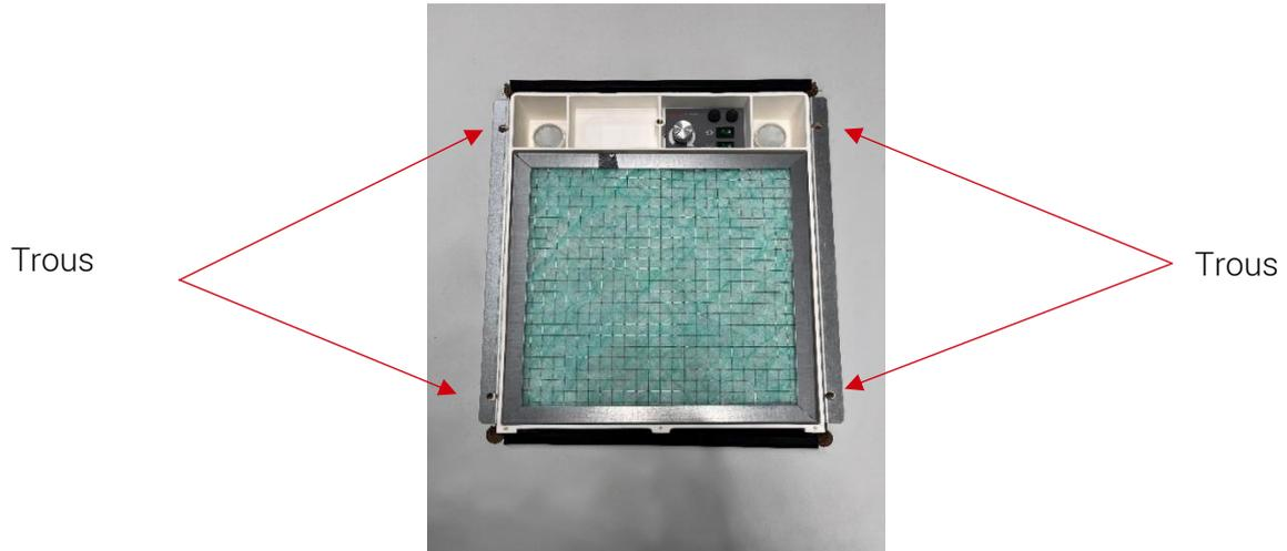
6. Installer le filtre et le préfiltre (optionnel), puis positionner la grille sur la table jusqu'en butée. Au besoin, compléter l'installation avec 4 écrous à visser sur les goujons de la grille (pour table épaisseur 20 à 30mm).
