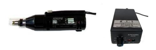
Machine à dénuder électrique pour fils vernis, l'abisofix se compose d'un groupe moteur et d'une tête de dénudage. La tête de dénudage est équipée de 3 lames en métal dur. Les lames se ferment grâce à la rotation. La vitesse est régulée par transformateur et ainsi la force de pression des lames est ajustée à chaque épaisseur de matériau.
