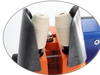
Machine à dénuder électrique pour fil de cuivre émaillé de  $\varnothing$  0.04 à  $\varnothing$  0.3 mm.
