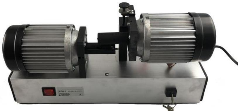
Le BTM 2 est une machine de table avec des brosses en acier pour le décapage des fils ronds de 0.2 mm à 6.0 mm et méplats jusqu'à 6 mm d'épaisseur et 20 mm de largeur. Il est possible de modifier l'axe de la machine pour utiliser des brosses de diamètre différent (22mm, 30 mm ou 40 mm).
