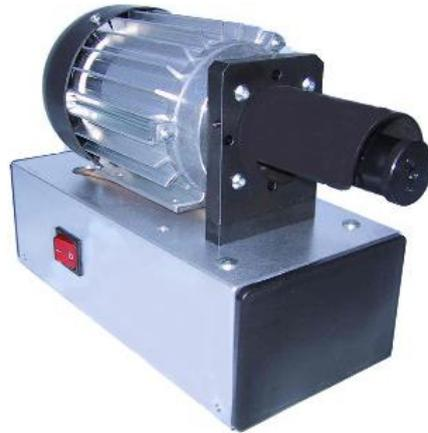
L'Abfräsfix est une machine automatique à dénuder les fils émaillés. Le fil est poussé à l'intérieur de la tête de décapage rotative jusqu'à la butée de longueur. Ainsi, les cinq lames tournent autour du fil tout en enlevant l'émail.
