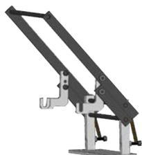
Pantographe d'étamage (sans bain)
