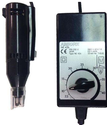
Machine à dénuder électrique pour fils vernis, l'abisofix se compose d'un groupe moteur et d'une tête de dénudage. La tête de dénudage est équipée de 3 lames en métal dur. Les lames se ferment grâce à la rotation. La vitesse est réglée par transformateur et ainsi la force de pression des lames est ajustée à chaque épaisseur de matériau.
