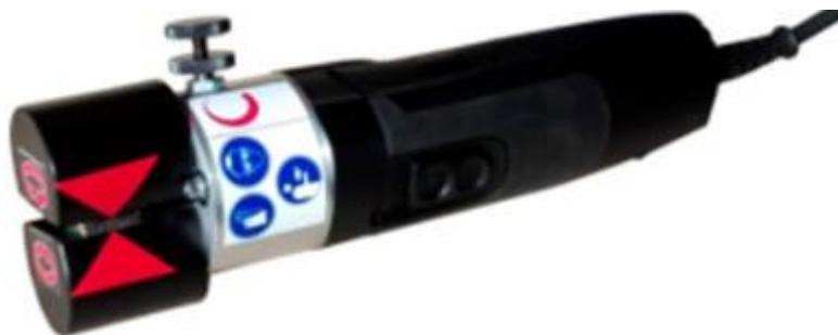
Machine à brosses, utilisée pour enlever l'émail des fils de diamètre 0.15 à 3 mm (HQ 30) et 1.5 à 6 mm (HQ 35 P) ainsi que les méplats de 1 à 6 mm (HQ 35 P).
