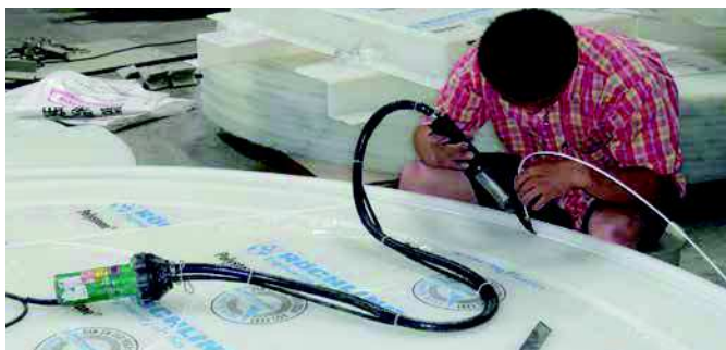
Soufflerie MINOR alimente en air la DIODE PID.
