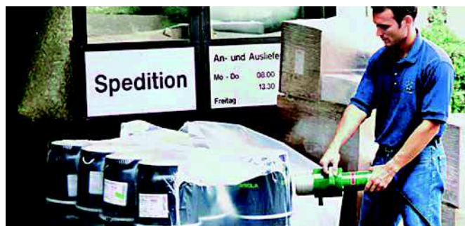
Thermorétraction sans flammes de palettes et de marchandises encombrantes dans des pièces fermées.
