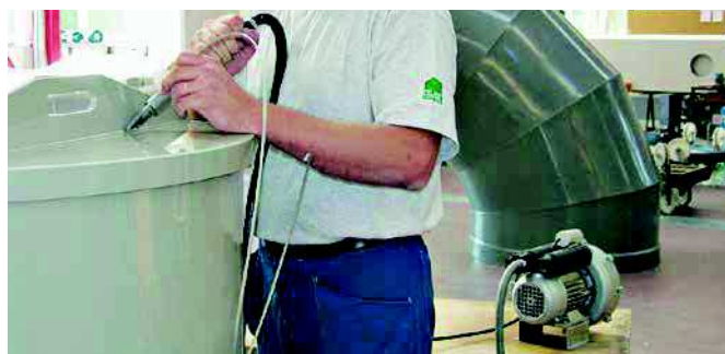
Soufflerie ROBUST pour alimentation en air du WELDING PEN.
