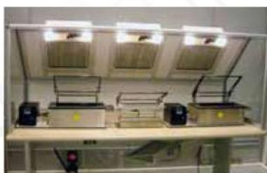
Exemple d'un poste complet dédorage/fluxage/etamage avec pantographe
