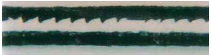
Soudé avec buse de serrage, résistance de cordon de soudure 25 % supérieure. Principalement pour les géomembranes TPO.
