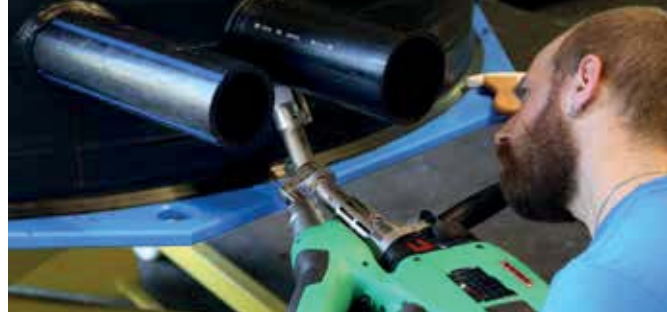
Les zones inaccessibles peuvent désormais être soudées avec les nouveaux adaptateurs à 45° et 90°.
