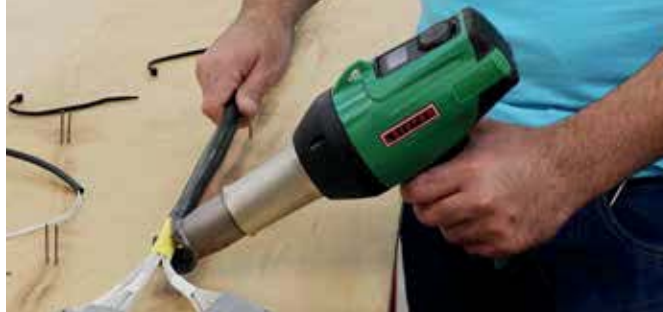
La thermorétraction pour confectionner des câbles – idéale avec GHIBLI AW
