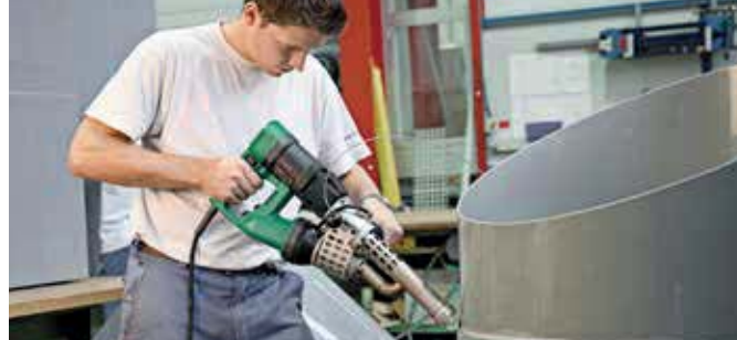
La FUSION 3C à l'oeuvre pour la construction de réservoirs.
