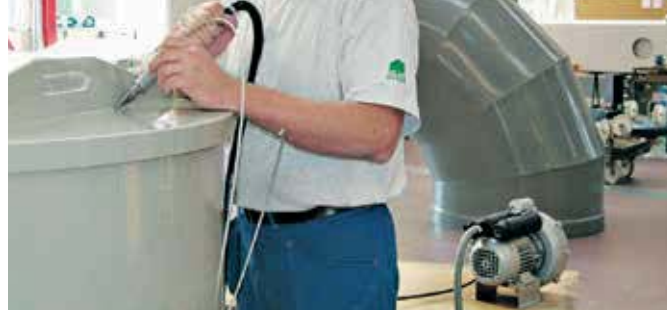
Soufflerie ROBUST pour alimentation en air du WELDING PEN.
