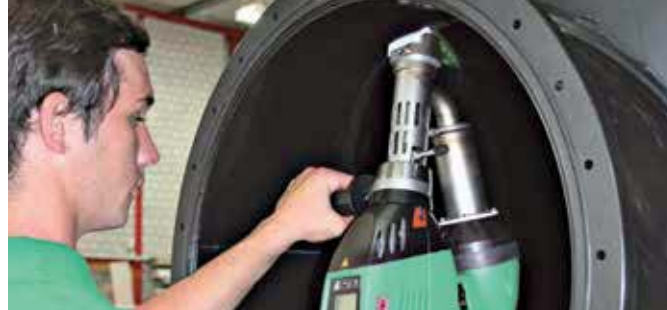
Soudage simple même des rayons intérieurs.
