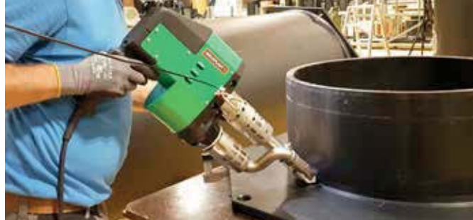
La puissante WELDPLAST S4 à l'oeuvre.
