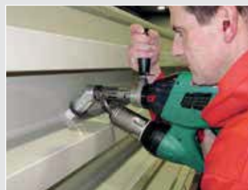
Le soudage est facilité dans les positions difficiles: grâce à la tête angulaire à 45° de la WELDPLAST S2. (Accessoire)
