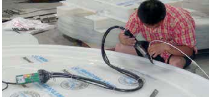
Soufflerie MINOR alimentée en air la DIODE PID.
