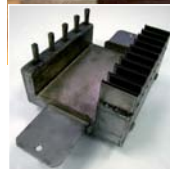
Ejemplo de un tubo multichorros para la soldadura de componentes complejos
