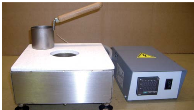
Crisole con pote amovible
